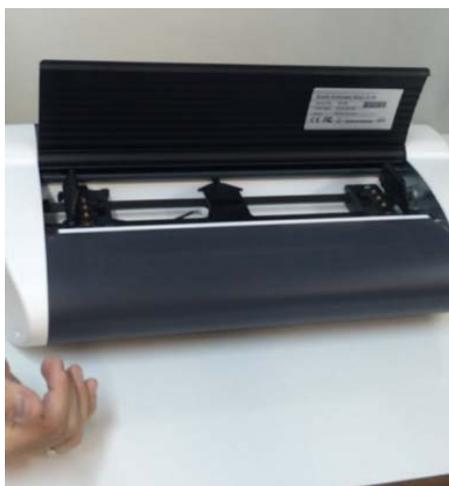
**Figura 38 – Impressora Basic D V4 com a tampa aberta**
