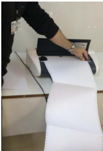
**Figura 39 – Colocação do papel na impressora Basic D V4**
