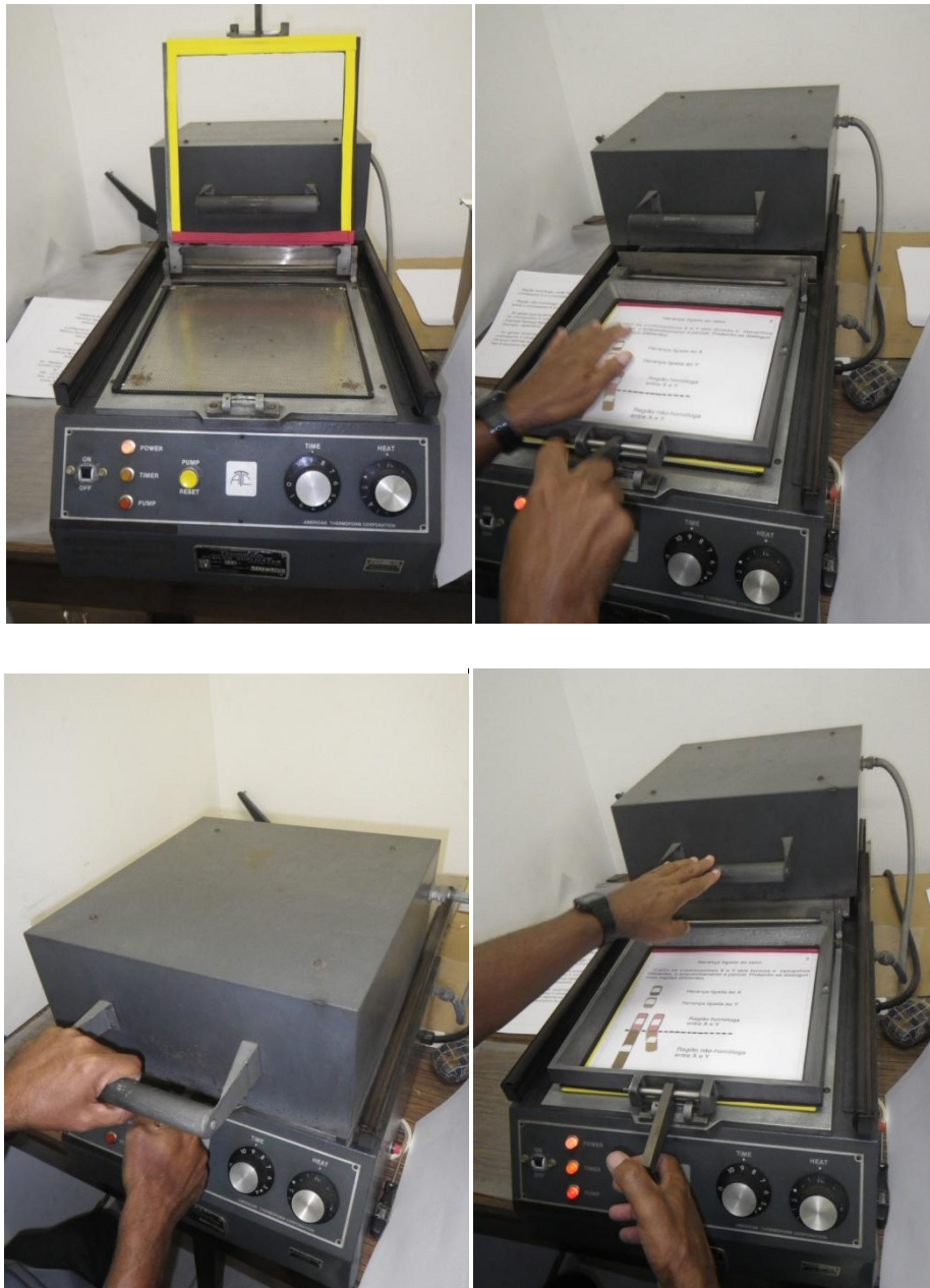
Figura 13: Processo de produção da película de PVC em alto relevo na máquina de thermoform (Sentido horário a partir da primeira imagem à esquerda).
