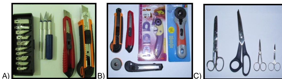
Figura 44: Três fotos de instrumentos de corte: A) Estiletes e bisturis. B) Estiletes para corte reto, circular e tracejado. C) Tesouras de diferentes tamanhos e tipos. (Foto: ROSA, P. I., 2015)
