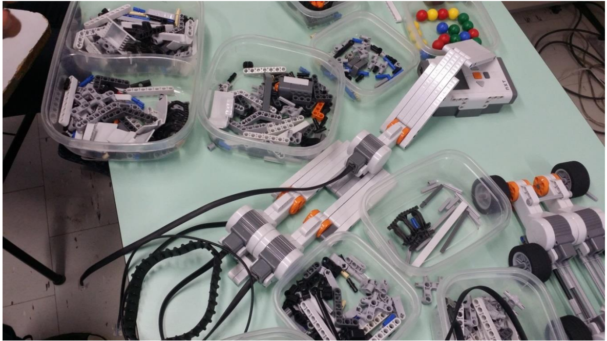
Figura 90: Criação de um braço mecânico feito pelos alunos A e D, com o intuito de auxiliar na criação de projetos que necessitem a elevação e a descida de algum objeto
