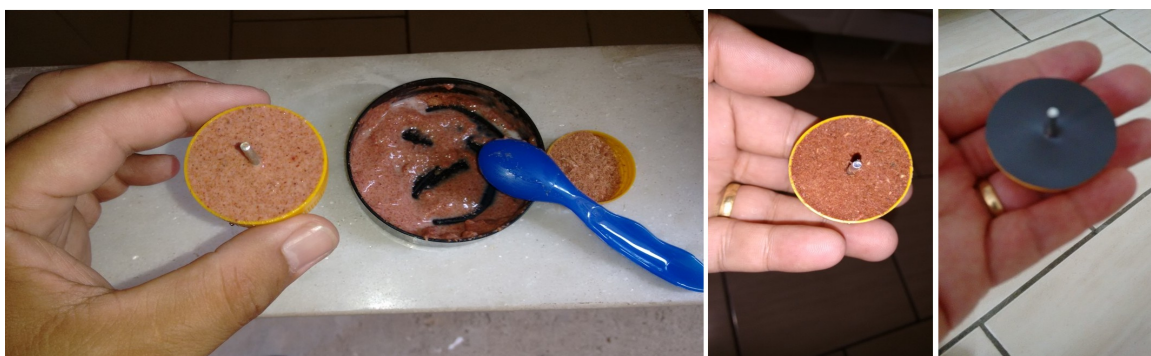
Figura nº 24 – Preenchimento com Serragem e Cola
