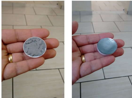
Figura nº 21 – Preenchimento com Massa Epox
